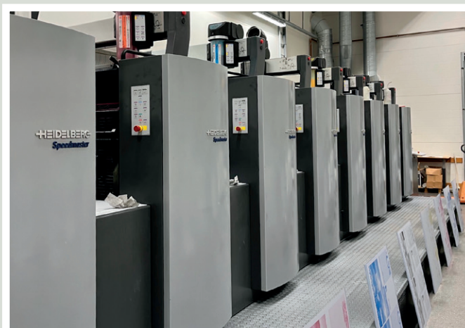
Etter det legges platene i en «plategate», med fire forskjellige farger, og sidene blir trykket.
